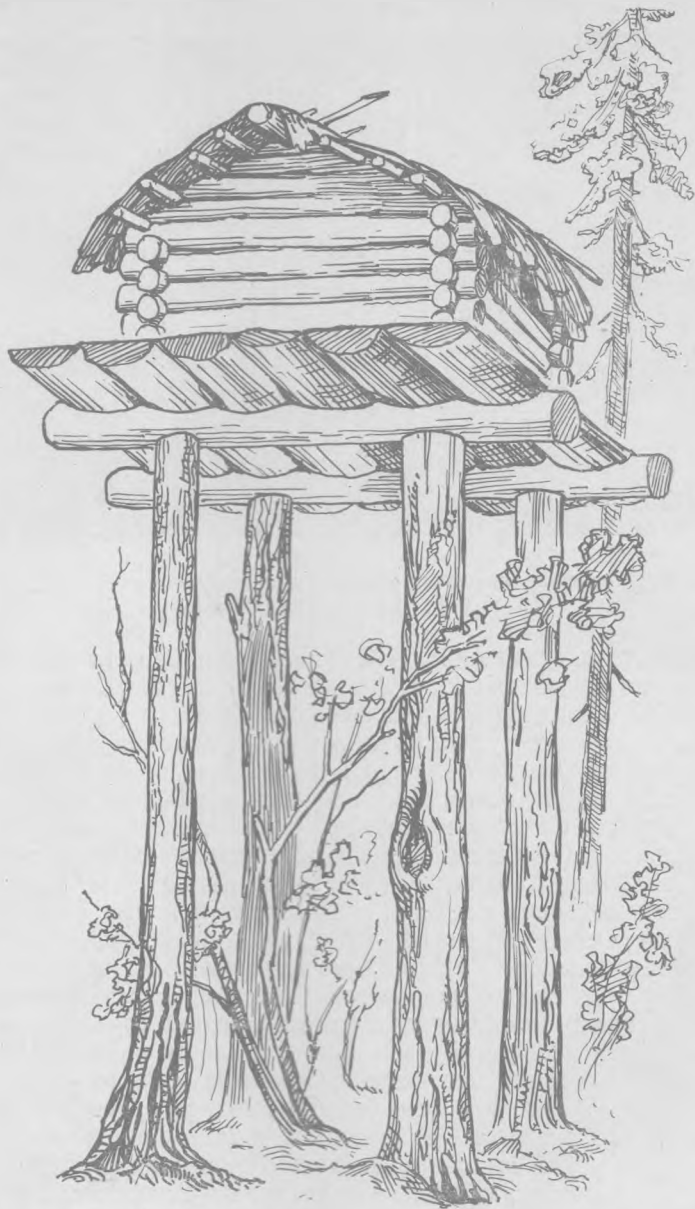
Рис. 3. Амбар, устроенный на стволах деревьев для длительного хранения шишек
