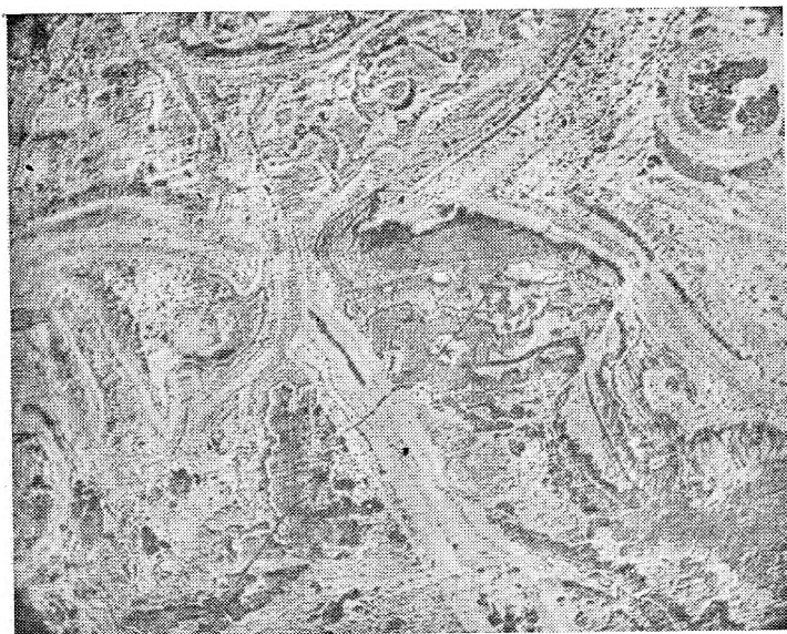
Рис. 3. Микроструктура окалины \text{Fe}_2\text{O}_3 при увеличении 300
