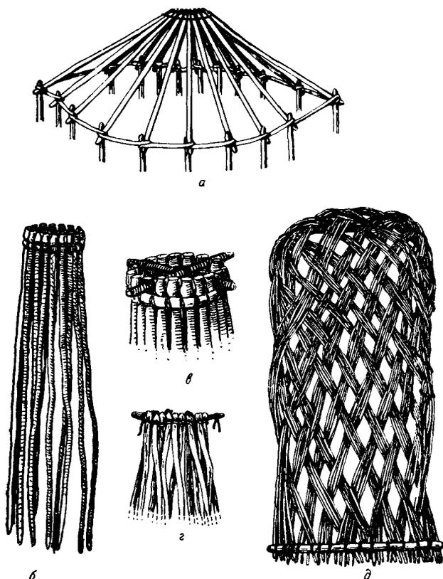
Рис. 4. *a* — способ привязывания остова крыши к кольям стены чаппари; *b* — остов крыши чаппари в сложенном виде (колл. МАЭ, № 3801-2); *в* — способ привязывания жердей крыши к увенчивающему ее кольцу; *г* — способ привязывания жердей крыши к палке; *д* — дверь чаппари, сплетенная из тальника (колл. МАЭ, № 4035—45)
